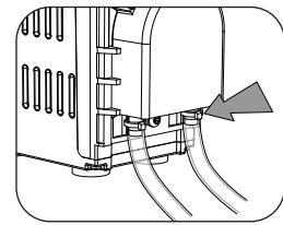
Controlar que el tubo de aspiración y de expulsión no estén retorcidos ni obstruido. El diámetro del tubo debe ser de 6mm y el exterior de 9mm. El tubo debe ser fijado con abrazaderas a la entrada y salida de la bomba.
