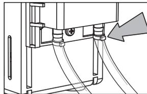
Entscheiden Sie welches Schwimmergehäuse für Ihre Installation das Richtige ist. Gehen Sie sicher, dass der Magnetring des Schwimmers nach oben zeigend eingebaut wird. Verbinden Sie den Schwimmerschalter mit der Kondensatwanne des Klimagerätes oder platzieren und befestigen den Schwimmerschalter innerhalb der Kondensatwanne. Es muss darauf geachtet werden, dass der Schwimmer waagrecht eingebaut wird.
