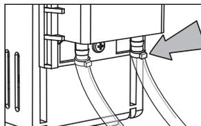
Vérifier que le bac de détection des condensats est bien adapté à votre installation.
