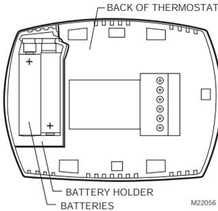
**Fig. 14. Installing batteries.**
